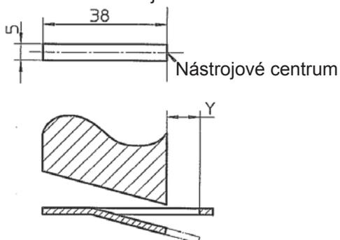
Délka (Dráha) X je délka nástroje a dělí se na délky s označením spodní úvrať 1 (pokračující dělení - viz níže) bude použita k postupnému dělení. Poslední zdvih musí být navíc naprogramován i s délkou označenou spodní úvrať 2 (hlouběji provedený stříh - viz. níže), aby délka stříhu mohla být přesně definována a výstupek byl odstraněn.
